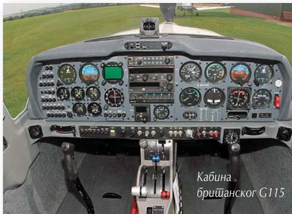
Авион G 115, који се користи у обуци будућих пилота британског RAF-а, неубичајен је по томе што ученици седе на десном седишту, како би левом руком управљали централном ручицом снаге
