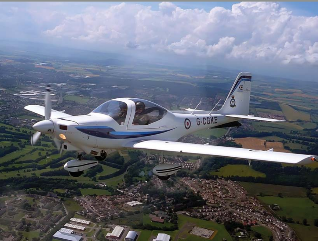
Авион G 115, који се користи у обуци будућих пилота британског RAF-а, неубичајен је по томе што ученици седе на десном седишту, како би левом руком управљали централном ручицом снаге
